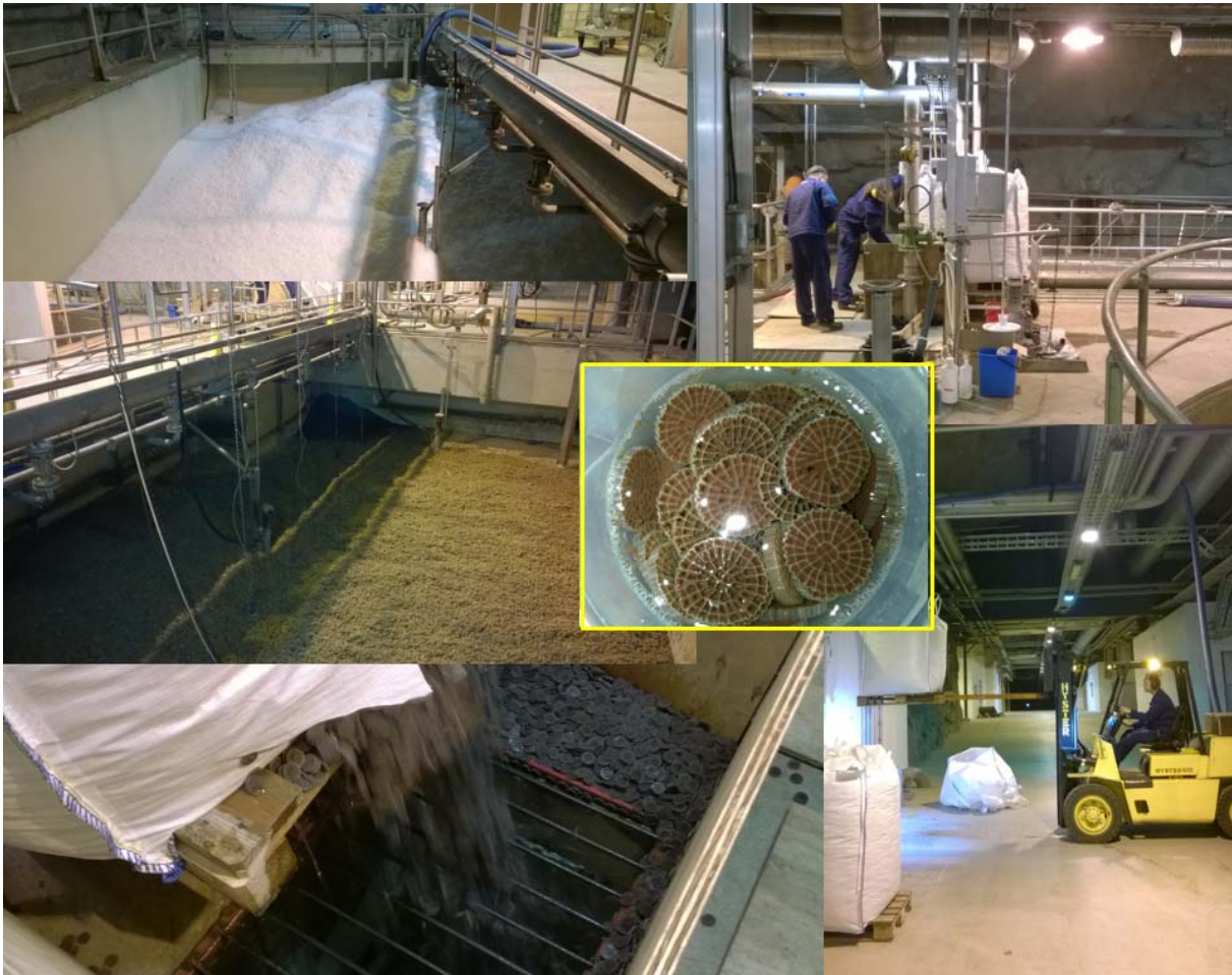
Kuva 1 Pilotin täyttöä ja käynnistyksen alkuvaiheita. Ylinä vasemmalla tilanne välittömästi kantoaineiden lisäämisen jälkeen, pilotin vedenpinta huomattavasti laskettuna, keskellä vasemmalla n. kuukauden ilmaston jälkeen, ennen siemenkantoaineiden lisäämistä. Muut kuvat siemenkantoaineiden lisääksestä.
